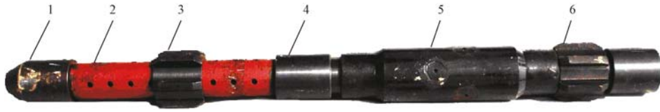
图 4 拖动式水力喷射压裂工具结构
