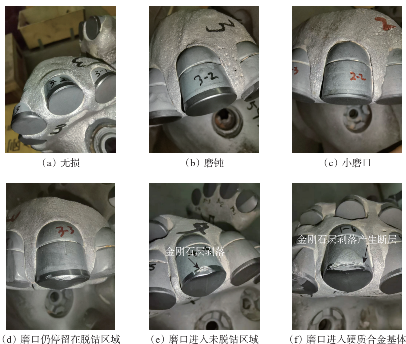
图 15 PDC 切削齿的典型出井状况
