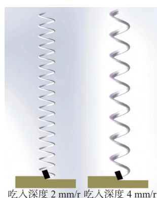
图5 相同进尺下PDC钻头吃入深度与切削齿行进距离的关系
