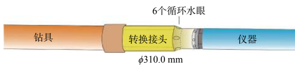
图 3 直推存储式测井转换接头
