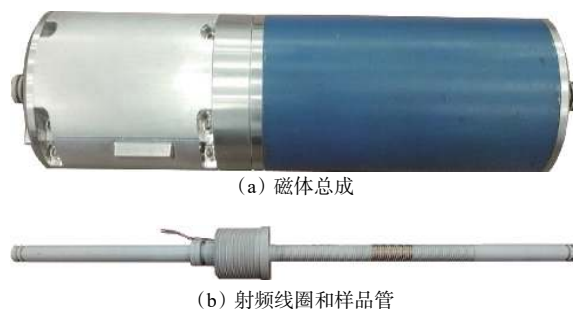
图4 井下随钻核磁共振流体探测器的磁体总成、射频线圈与样品管
