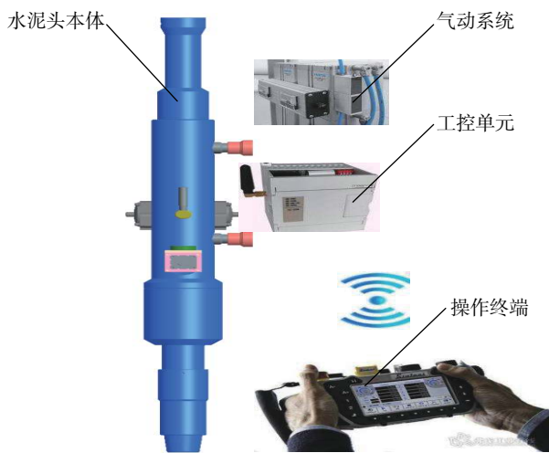
图 4 自动化控制井口装置的结构组成
