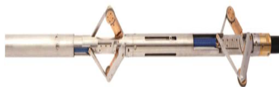
图1 GE-Sondex公司的轮式牵引机器人 [10]
