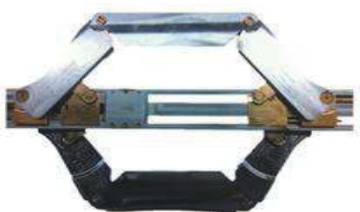
图 2 刀片式三连杆支撑机构伸缩式井下牵引机器人 [12]
