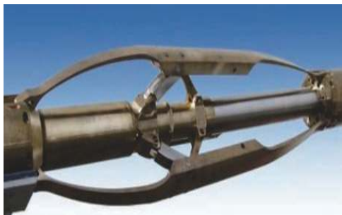
图 4 WWT 公司伸缩式井下钻井机器人 [14]
