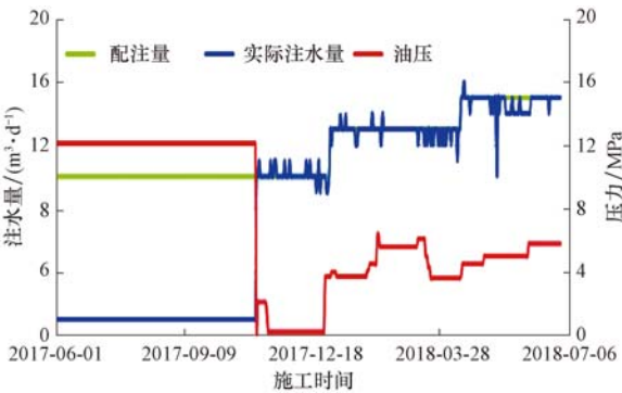
图 5 Y1-01 井采用不动管柱脉冲式酸化增注技术前后的注水曲线
