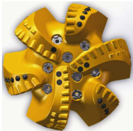
图 2 锥形辅助切削齿 PDC 钻头三维模型
