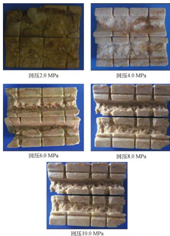
图5 不同回压下胶凝酸的酸蚀裂缝形态
