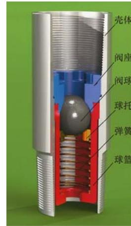
图1 高性能弹浮式套管浮箍结构
