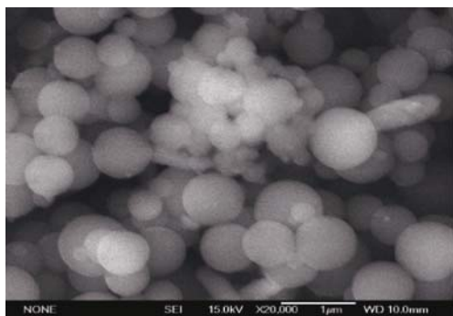
图3 球状凝胶扫描电镜照片(放大20 000倍)
