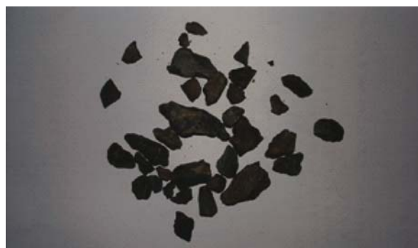
图 8 TKX-CH 井复杂泥岩造斜段井下掉块
