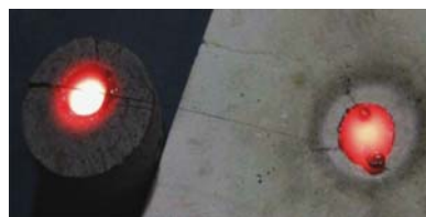
图 2 微波作用下岩石熔化情况
