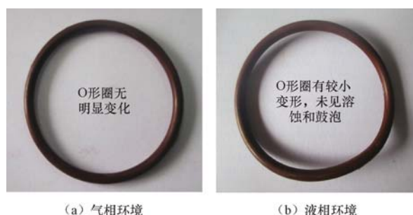
图 9 氢化丁腈橡胶 O 形圈腐蚀后的形貌
