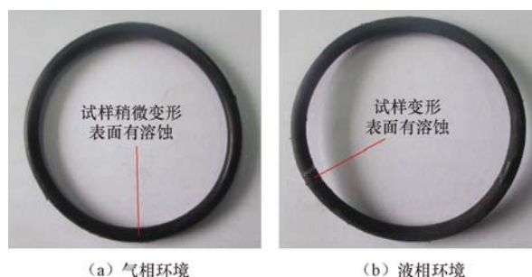
图 8 丁腈橡胶 O 形圈腐蚀后的形貌
